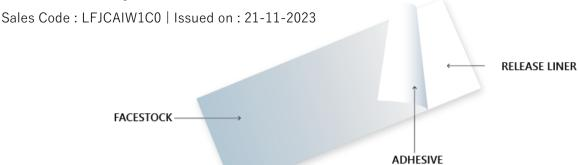
FACESTOCK BOPP (BIAXIALLY ORIENTED POLYPROPYLENE) FILM
