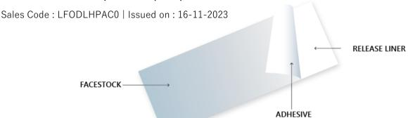
FACESTOCK BOPP (BIAXIALLY ORIENTED POLYPROPYLENE) FILM
