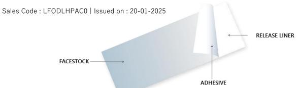
FACESTOCK BOPP (BIAXIALLY ORIENTED POLYPROPYLENE) FILM
